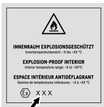
Fig. 3 Classe de protection : II 3/-G Ex ec IIC T6 Gc/-
