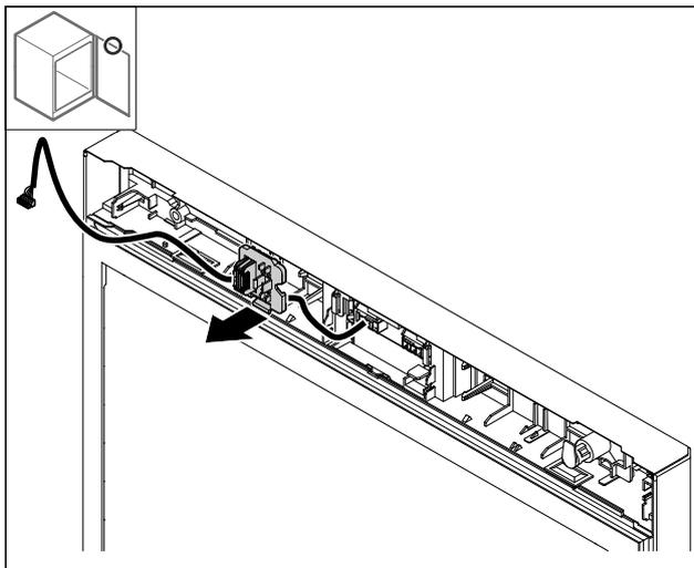
Fig. 29 Vous pouvez tourner le support de connecteur à 180° pour le monter dans la position inverse.
