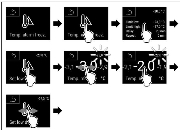
Fig. 140 Exemple pour le réglage du seuil inférieur de température en se basant sur une température d'appareil définie de -20 °C.
