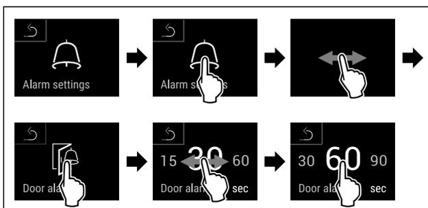
Fig. 150 Représentation à titre d'exemple : modification de l'alarme de porte de 30 secondes à 60 secondes.
