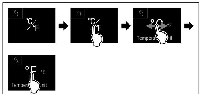
Fig. 92 Représentation à titre d'exemple : Passer du degré Celsius au degré Fahrenheit.
