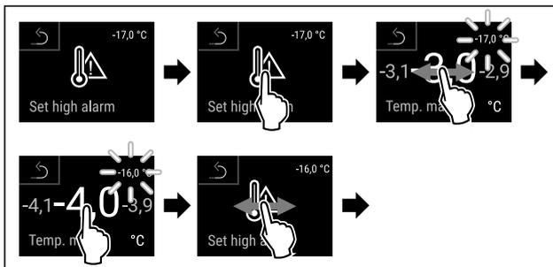
Fig. 141 Exemple pour le réglage du seuil supérieur de température en se basant sur une température d'appareil définie de -20 °C.
