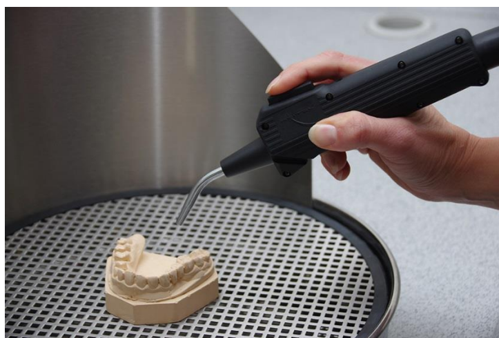
Manipulation du pistolet lors du nettoyage ponctuel
