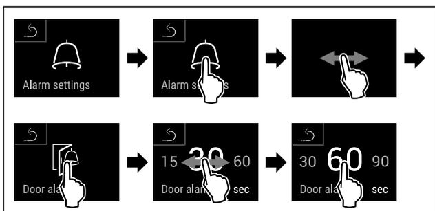
Fig. 190 Représentation à titre d'exemple : modification de l'alarme de porte de 30 secondes à 60 secondes.
