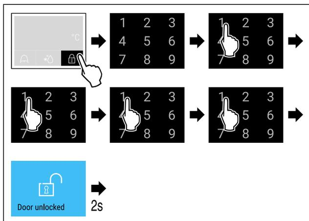
Fig. 77 Déverrouillage de la porte avec le code de porte 1 1 1.
