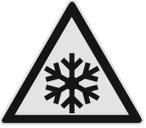
**AVERTISSEMENT : Surface froide !** Toucher uniquement avec une protection des mains appropriée. Cet autocollant ou un autocollant similaire peut se trouver sur l'appareil et indique un risque de gelure.
