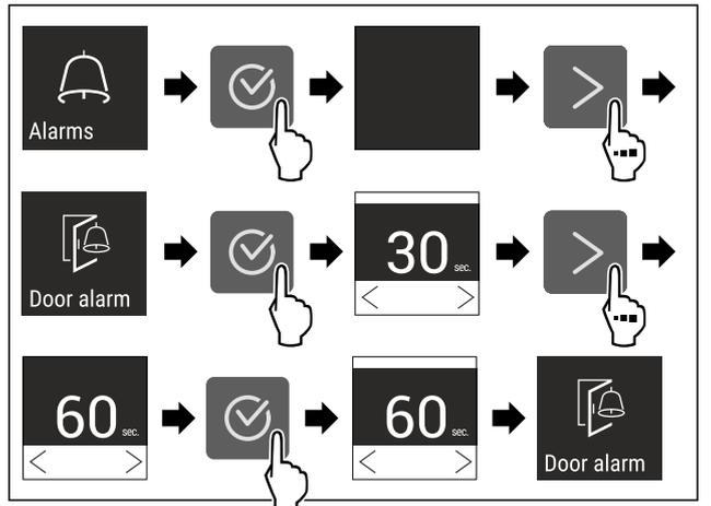
Fig. 139 Représentation à titre d'exemple : modification de l'alarme de porte de 30 secondes à 60 secondes.
