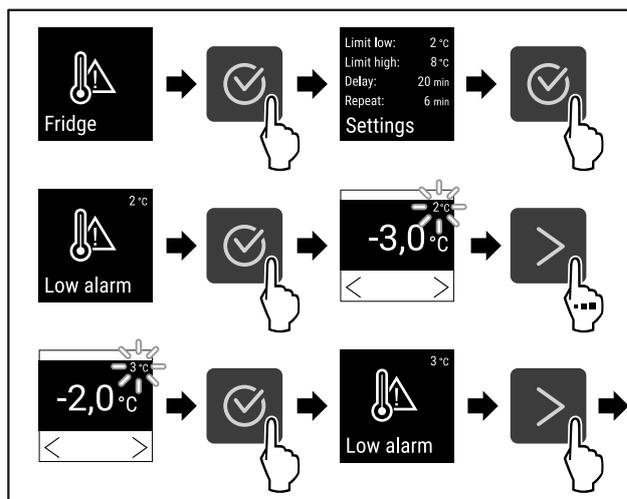
Fig. 137 Exemple pour le réglage du seuil inférieur de température en se basant sur une température d'appareil définie de 5 °C.
