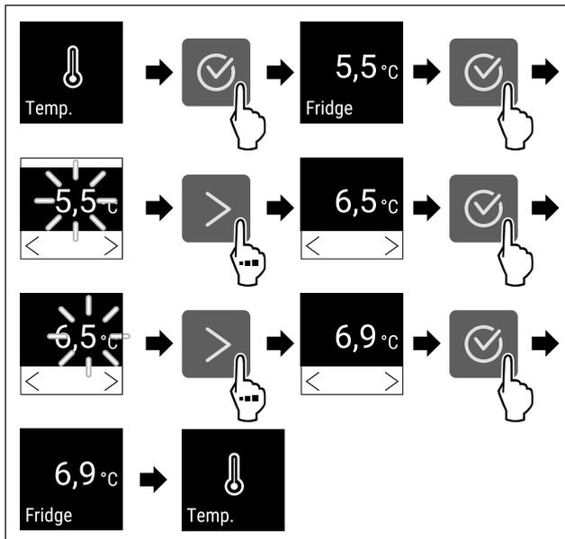
Fig. 91 Changement de température de 5,5 °C à 6,9 °C
