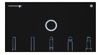
Die fünf Zeichnungen auf der Unterseite des Bildschirms zeigen die fünf verschiedenen Leuchtmittel , die von den entsprechenden Lichtquellen vorne am Gerät unterstützt werden. Wenn Sie nicht sicher sind, welche Quelle Ihrem Leuchtmittel entspricht, können Sie auf das Bild am Bildschirm drücken und ein Foto des jeweiligen Anschlusses wird angezeigt.
