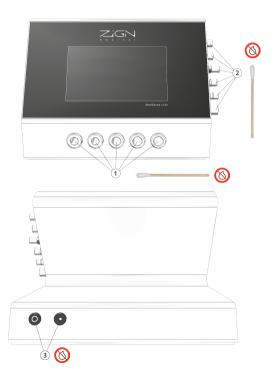
Reinigen Sie die Lichtquellen mit einem fusselfreien, trockenen Wattestäbchen
