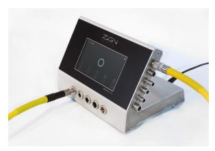
Jetzt kann der Adapter der Lichtquelle in die entsprechende Lichtquelle gesteckt werden. Bitte stellen Sie sicher, dass Sie die richtige Lichtquelle verwenden. Die Bildschirmanzeige sollte Ihnen die richtige Richtung zeigen. Wenn Sie die richtige Lichtquelle ausgewählt haben, sollte der Adapter einen guten Sitz haben, mit wenig Spielraum in der Lichtquelle. Sie müssen den Adapter vollständig an der Lichtquelle einstecken.
