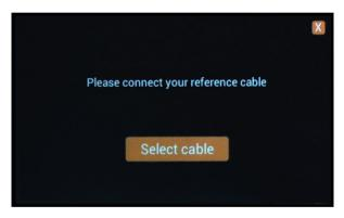
Choisissez un câble de test de bonne qualité (de préférence neuf) que vous souhaitez utiliser pour tester vos endoscopes. Il est recommandé de toujours utiliser le même câble de test afin de minimiser les différences entre les différentes mesures. Le câble de test sélectionné doit avoir un débit de lumière d'au moins 75%.
